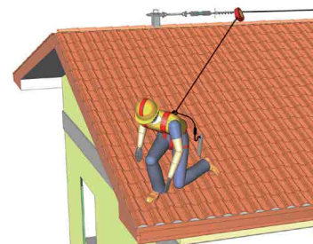
Ancoraggio per collegamento secondo cordino
